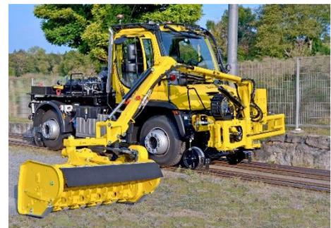
Unimog mit Dücker-Frontmäherät UNA 500
