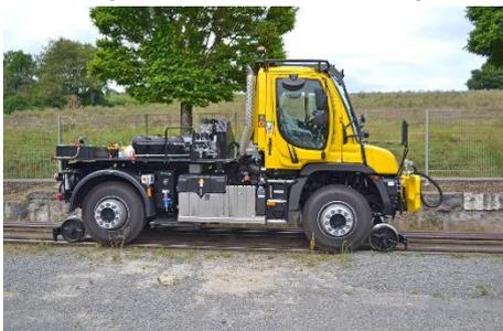
ZAGRO Rangierfahrzeug Unimog mit Waggonbremsanlage
